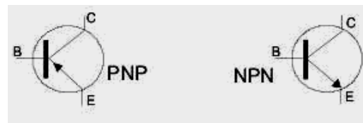
Gambar 2.11. Simbol Transistor PNP dan NPN
