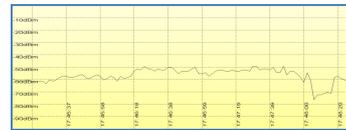
Gambar 4.13 Grafik level sinyal (dBm) pada jarak + 40 meter
