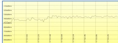
Gambar 4.7 Grafik level sinyal (dBm) pada jarak ± 20 meter
