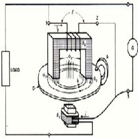
Gambar 2.1 Sistem KWh Meter
