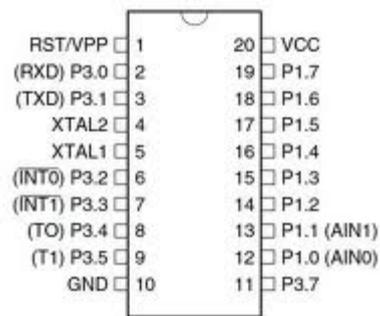
Gambar 2.6 Mikrokontroler AT89C2051
