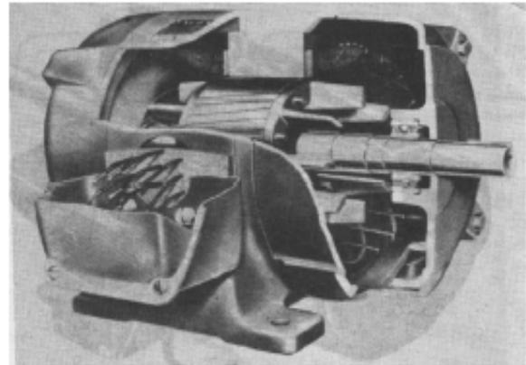
Gambar 2.2 Penampang Motor Induksi Rotor Sangkar <sup>[1]</sup>
