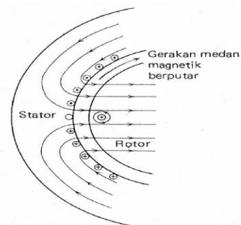
Gambar 2.4 Penampang rotor dan stator pada motor induksi memperlihatkan medan magnet dalam celah udara<sup>[2]</sup>
