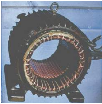
2.1 Stator Motor Induksi 3 Fasa [5]
