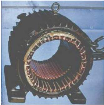
2.1 Stator Motor Induksi 3 Fasa <sup>[5]</sup>
