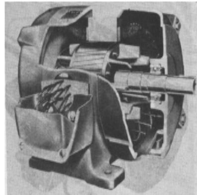
Gambar 2.7 Motor Induksi Sangkar Bajing<sup>[1]</sup>
