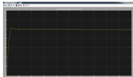
Gambar 4-6 Hasil keluaran gambar 4-5 simulasi simulink fungsi alih motor induksi menggunakan kendali PID dengan K_p=25 , K_i=1.2 dan K_d=48.75 Kemudian juga dilakukan tuning terhadap kendali PID tersebut agar hasilnya makin baik dibandingkan dengan gambar 4-6, seperti pada gambar 4-7 dapat dilihat dibawah ini.
