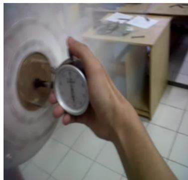
Gambar 8 Pengukuran kecepatan putaran dengan Tachometer
