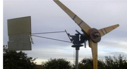
Gambar 1 Turbin angin sumbu horizontal.
