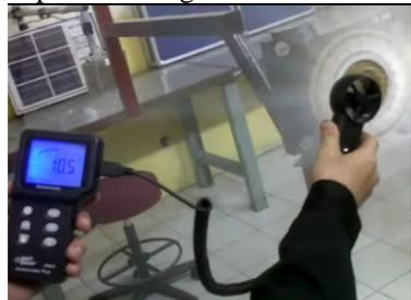
Gambar 9 Pengukuran kecepatan angin dengan Anemometer
