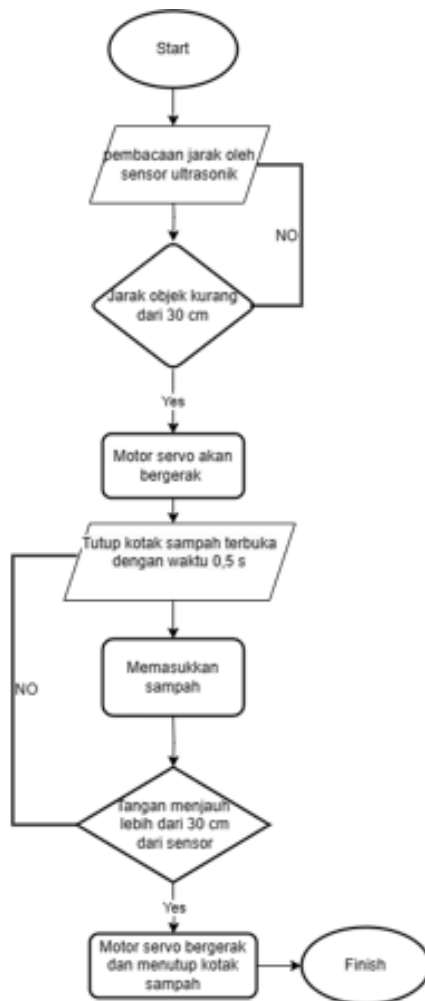
Gambar 3.4 Flowchart Cara Kerja Alat (Sumber: Dokumentasi, 2023)
