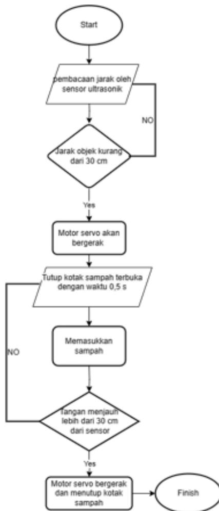
Gambar 3.4 Flowchart Cara Kerja Alat
