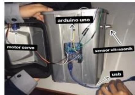
Gambar 4.1 Tampak Keseluruhan Alat
