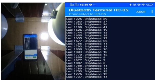
Gambar 9. Pengujian Lux Kondisi Ruang Redup
