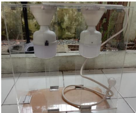
Gambar 5. Prototype Sistem Kontrol Intensitas Cahaya
