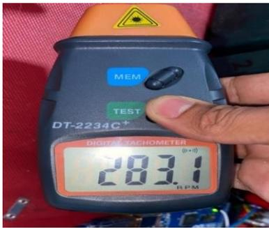
Gambar 10. Data yang dihasilkan pada tachometer
