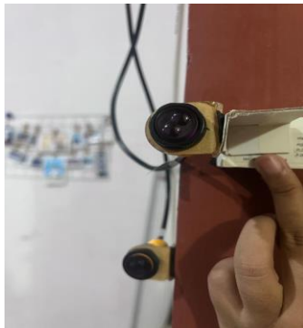
Gambar 16. Penempatan Sensor IR 1 dan 2
