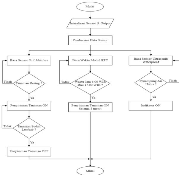
Gambar 16. Flowchart Sistem Kontrol Penyiraman Tanaman Otomatis
