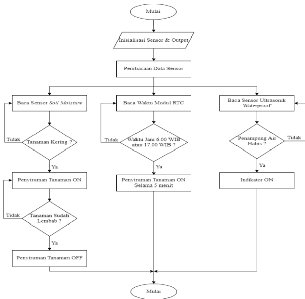
Gambar 16. Flowchart Sistem Kontrol Penyiraman Tanaman Otomatis
