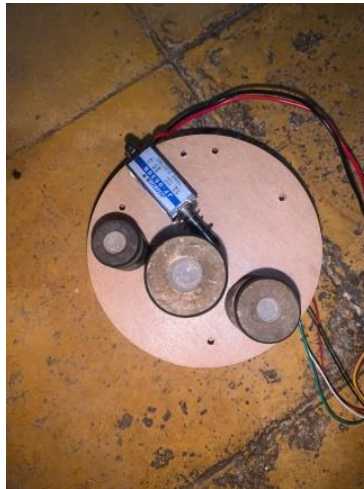
Gambar 5 Pengujian Load Cell
