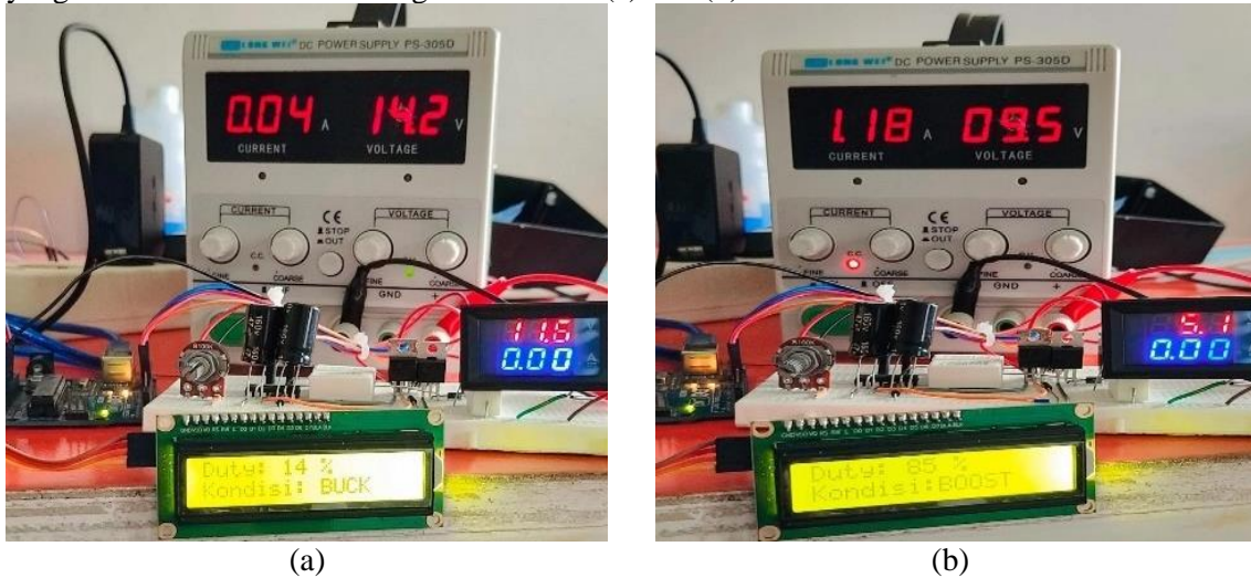
Gambar 4 (a) Kondisi konverter buck (b) Kondisi konverter boost
