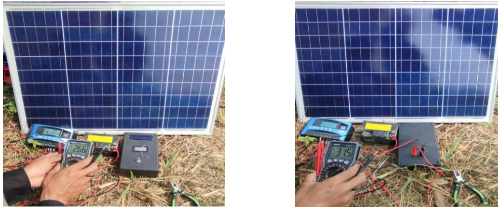
Gambar 5 (a) Kondisi konverter buck (b) Kondisi konverter boost
