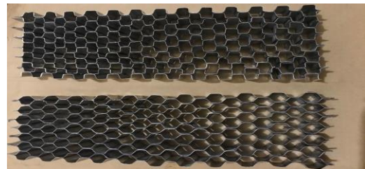
Gambar 6 Sample sandwich panel untuk uji bending load
