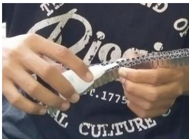
Gambar 4 Menyatukan Bagian Core Dengan Perekat
