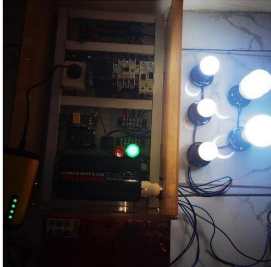
Gambar 8 Kondisi Indikator Saat Terhubung Ke PLN
