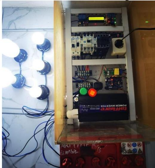
Gambar 9 Kondisi Indikator Setelah Switching ke Baterai
