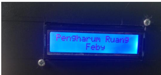
Gambar 10 Tampilan LCD(Liquid Chrystal Display)saat pertama kali alat di hidupkan
