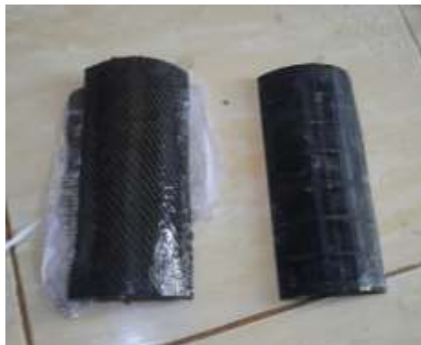
Gambar 3. Melepaskan Komposit dari Cetakan
