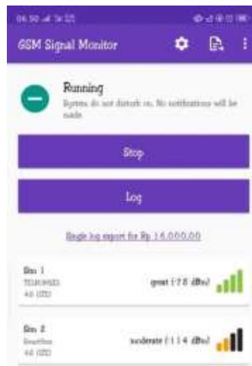
**Gambar 6. Tampilan Hasil Tanpa Antena**
