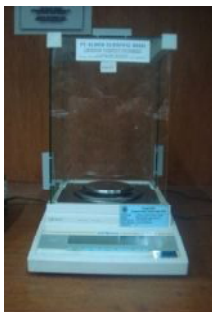
Gambar 3.5 Timbangan digital dengan ketelitian 0.0001 gram.
