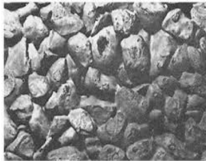
Gbr 2. Struktur Lekatan beton tanpa pasir
