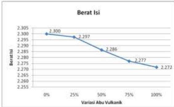
**Gambar 8** Hasil Pengujian Pengaruh Kadar Abu Vulkanik Terhadap Nilai Density Campuran AC-WC
