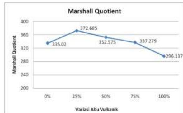
**Gambar 14** Hasil Pengujian Pengaruh Kadar Abu Vulkanik Terhadap Nilai Marshall Quotient Campuran AC-WC
