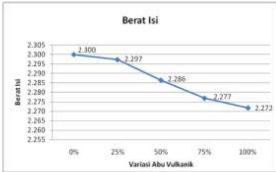
Gambar 8 Hasil Pengujian Pengaruh Kadar Abu Vulkanik Terhadap Nilai Density Campuran AC-WC
