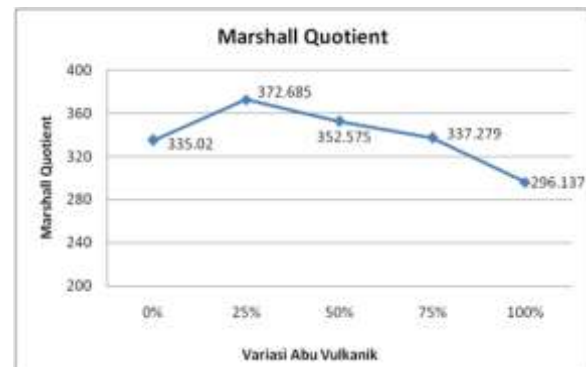
Gambar 14 Hasil Pengujian Pengaruh Kadar Abu Vulkanik Terhadap Nilai Marshall Quotient Campuran AC-WC
