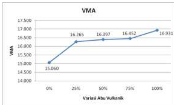
Gambar 9 Hasil Pengujian Pengaruh Kadar Abu Vulkanik Terhadap Nilai Void in Mineral Aggregate (VMA) Campuran AC-WC
