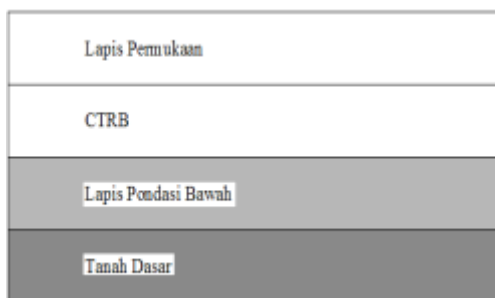
Gambar 3. Struktur Perkerasan dengan CTRB
