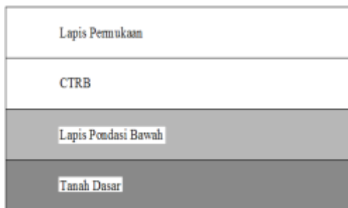
Gambar 3. Struktur Perkerasan dengan CTRB
