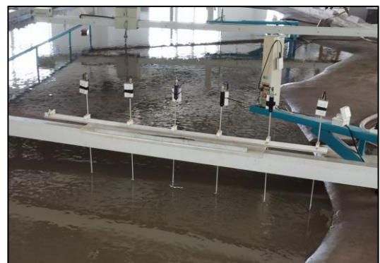
Gambar 6. Sistem Pengukuran Kecepatan Aliran
