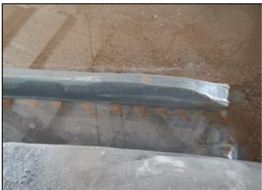
Gambar 23. Distribusi Pengendapan Sedimen di Sisi Hilir Saluran Memanjang pada Kondisi 3 dengan Debit Aliran 104,61 m 3 /detik
