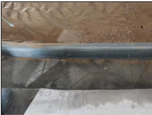
Gambar 22. Distribusi Pengendapan Sedimen di Sisi Tengah Saluran Memanjang pada Kondisi 3 dengan Debit Aliran 104,61 m 3 /detik
