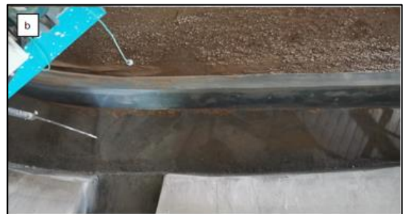
Gambar 25. Distribusi Pengendapan Sedimen di Sisi Tengah Saluran Memanjang pada Kondisi 4 dengan Debit Aliran 260 m 3 /detik
