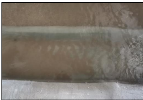
Gambar 14. Pengendapan Sedimen yang Terjadi di Sisi Tengah Saluran Memanjang pada Pengujian Kondisi 3
