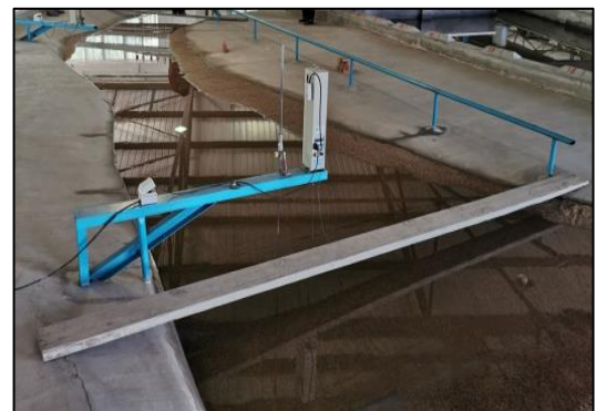
Gambar 5. Sistem Pengukuran Level Permukaan Air
