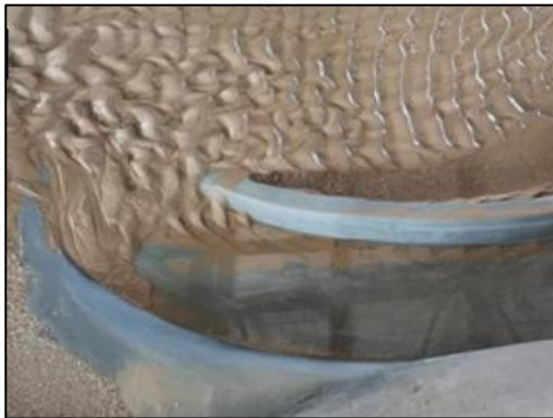
Gambar 21. Distribusi Pengendapan Sedimen di Sisi Hulu Saluran Memanjang pada Kondisi 3 dengan Debit Aliran 104,61 m 3 /detik
