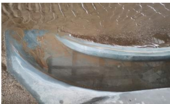
Gambar 27. Distribusi Pengendapan Sedimen di Sisi Hulu Saluran Memanjang pada Kondisi 5 dengan Debit Aliran 600 m 3 /detik
