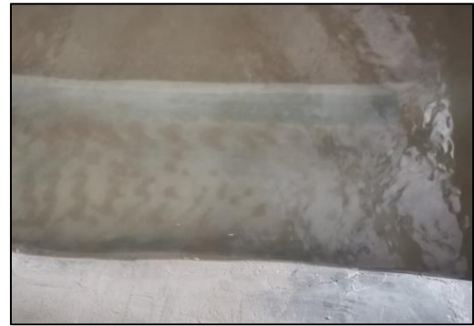
Gambar 15. Pengendapan Sedimen yang Terjadi di Sisi Hilir Saluran Memanjang pada Pengujian Kondisi 3
