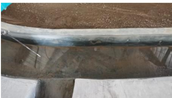
Gambar 28. Distribusi Pengendapan Sedimen di Sisi Tengah Saluran Memanjang pada Kondisi 5 dengan Debit Aliran 600 m 3 /detik
