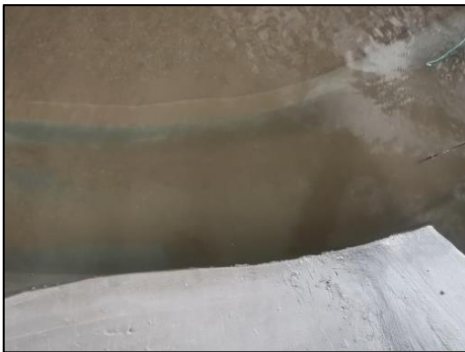
Gambar 13. Pengendapan Sedimen yang Terjadi di Sisi Hulu Saluran Memanjang pada Pengujian Kondisi 3
