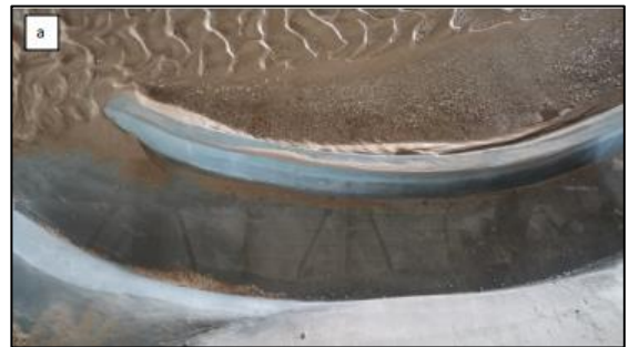
Gambar 24. Distribusi Pengendapan Sedimen di Sisi Hulu Saluran Memanjang pada Kondisi 4 dengan Debit Aliran 260 m 3 /detik
