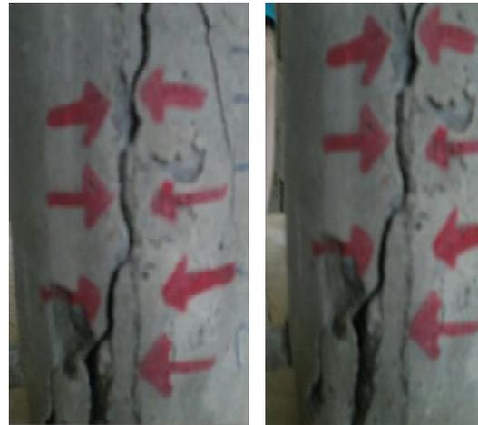
Gambar 9. Retak Pada Benda Uji Beton Umur 14 dan 28 Hari
