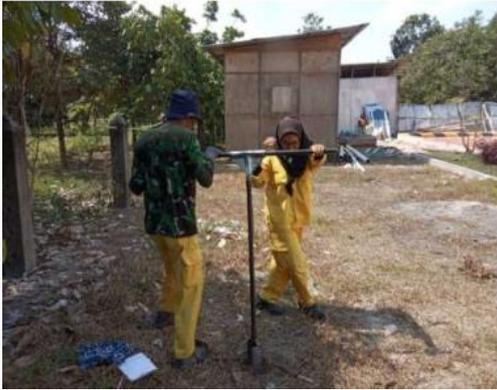
Gambar 4. Pengujian Muka air tanah menggunakan hand boring
