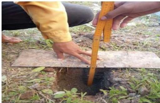
Gambar 5. Pembuatan lobang uji permeabilitas tanah
