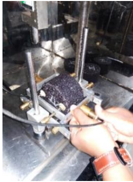
Gambar 2. Pengujian Modulus Resilien
