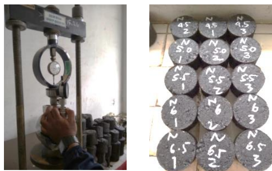
Gambar1. Pengujian Stabilitas Marshall
