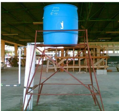
Gambar 1. Unit pengolahan air gambut secara sederhana
