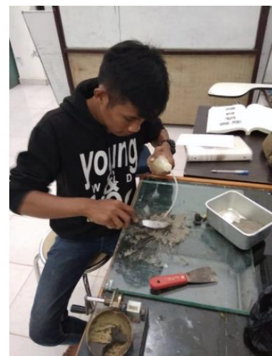
Gambar 9. Pengujian Indeks Plastisitas Tanah (Plastis limit dan Liquid limit)
