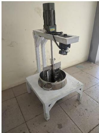
Gambar 2. Mesin pengaduk susu kedelai
