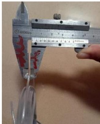
**Gambar 4.** Pengukuran Diameter Filamen
