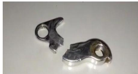
Gambar 2. Rear Derailleur Hanger Patah
