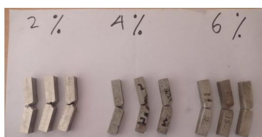
**Gambar 7.** Hasil Pengujian Impak
