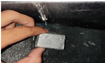
Gambar 6. Proses Pengampalsan Hasil Pengecoran
