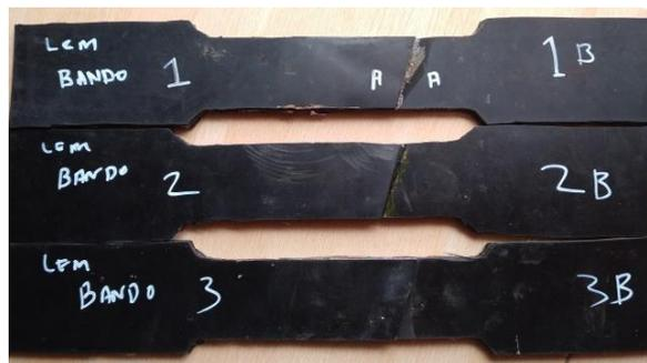
**Gambar 3.** Sambungan *Cold Splicing* Dengan Lem Sunpat Eco
