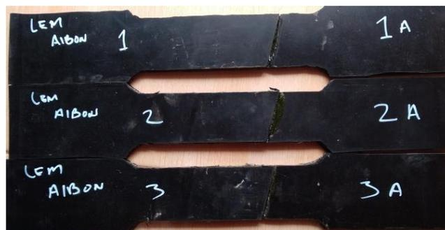
**Gambar 4.** Sambungan *Cold Splicing* Dengan Lem Aibon
