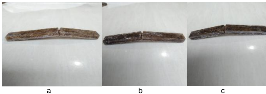
Gambar 7. Spesimen pengujian Bending variasi alkali a. 0%, b. 5% dan c. 7 %
