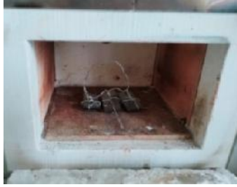
Gambar 3. Proses Memasukkan Spesimen kedalam Furnace
