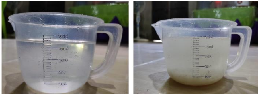
Gambar 6. Proses pembuatan larutan dengan kandungan garam 10%
