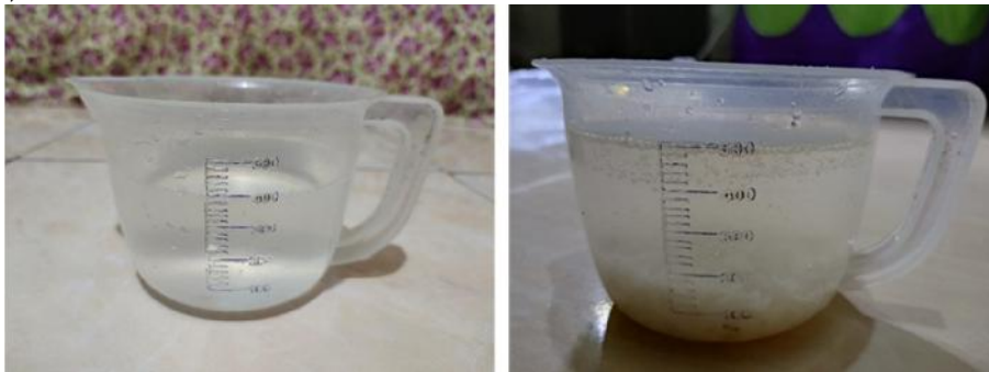
Gambar 7. Proses pembuatan larutan dengan kandungan garam 20%
