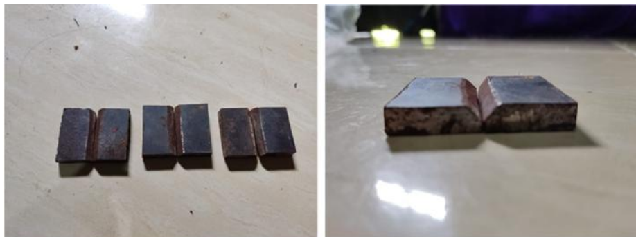
Gambar 5. Pembentukan kampuh pada spesimen
