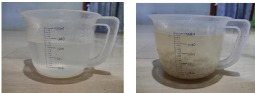
Gambar 8. Proses pembuatan larutan dengan kandungan garam 30%
