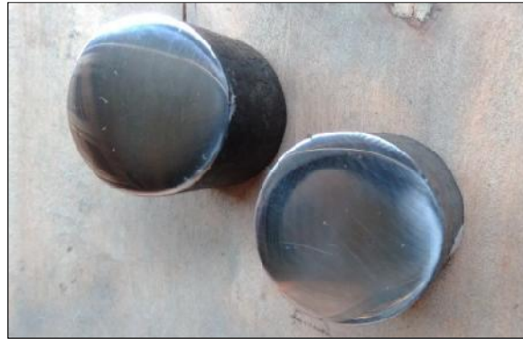
Gambar 3. Spesimen Uji Struktur Mikro
