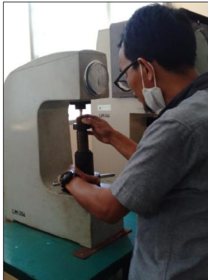
Gambar 2. Proses Pengujian Kekerasan
