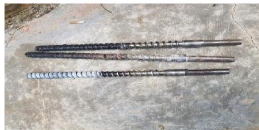
**Gambar 3.** Screw dengan sudut  $0^\circ$ ,  $15^\circ$ . dan  $25^\circ$ .
