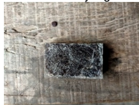
Gambar 3. Komposit Dikeluarkan dari Cetakan
