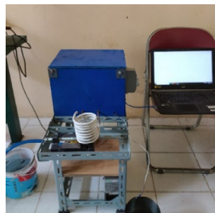
Gambar 2. Persiapan Pemanas Induksi
