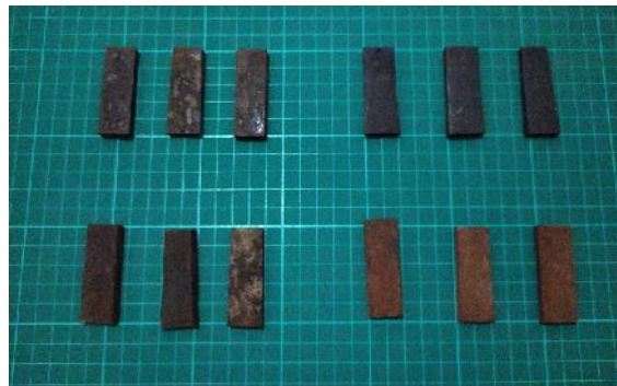
Gambar 5. Spesimen Uji Setelah Dilakukan Proses Hardening
