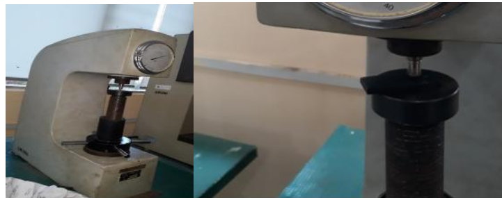
Gambar 6. Proses Pengujian Kekerasan
