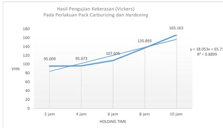
**Gambar 3.** Grafik kekerasan Pada Non Perlakuan dan perlakuan *Pack Carburizing & hardening*
