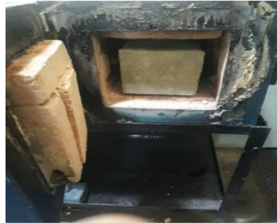
Gambar 1 Pembakaran Beton Dengan Dapur Pemanas
