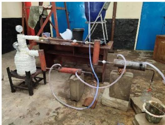
Gambar 1. Alat Pengujian: Pengolahan Limbah Oli Bekas
