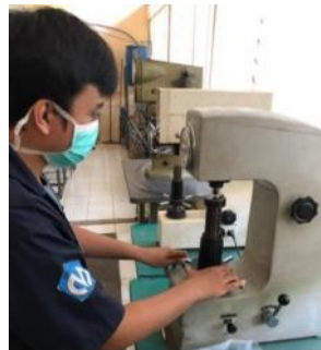
Gambar 7. Proses pengujian kekerasan
