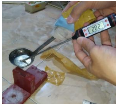
Gambar.6 Proses penuangan dan Pengukuran suhu tuang
