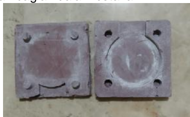
Gambar.5 Cetakan Silicone Mold Max 60™ yang telah di tabur tepung talk
