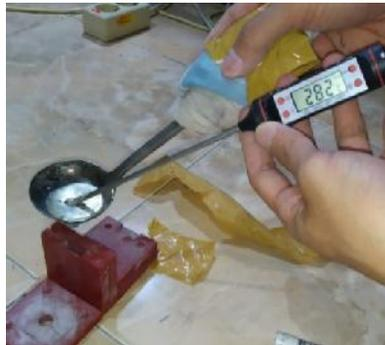
**Gambar.6** Proses penuangan dan Pengukuran suhu tuang
