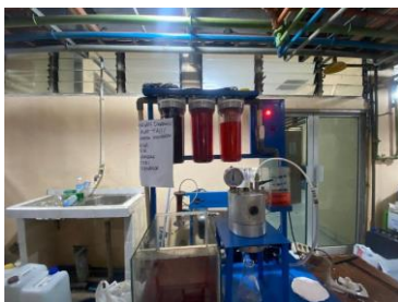
Gambar 2. Pengaplikasian Membran Dalam Pengolahan Limbah Kain Jumputan Dengan Alat Ultrafiltrasi
