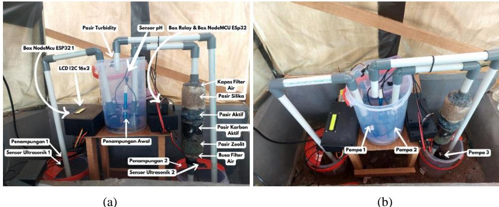
Gambar 7 Sistem Kendali dan Pemantauan Filter Air pada (a) dan (b)
